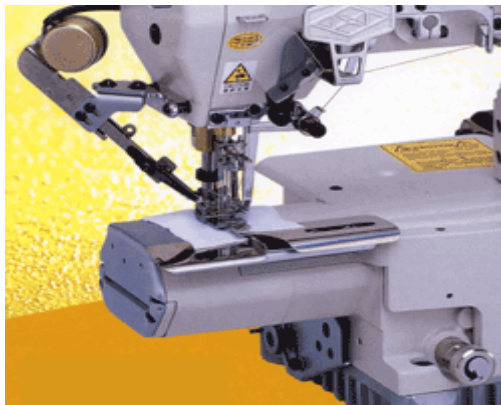
調節式布誘導器、活動壓腳舌。 Adjusting fabric guide, and adjustable presser foot.
